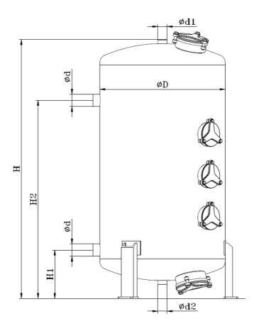
• Фильтры диаметром более 1600 мм (64") оснащены сервисным люком диаметром 18".
